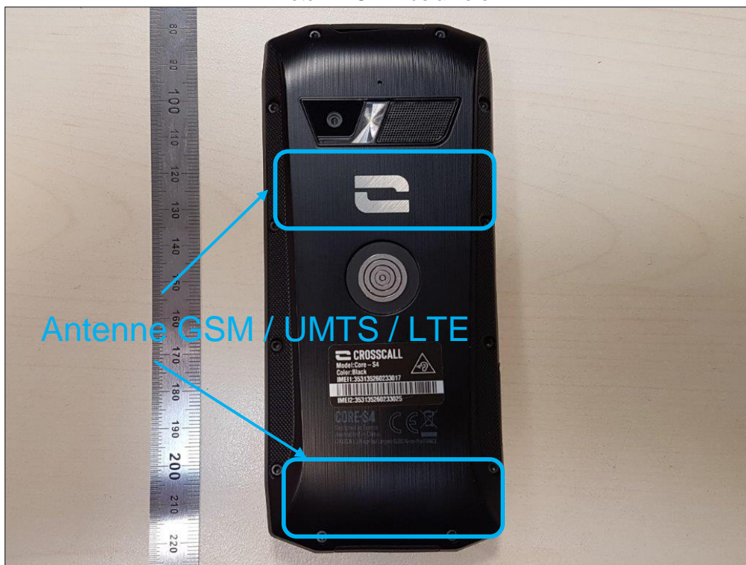
Photo 4: EST – vue arrière
