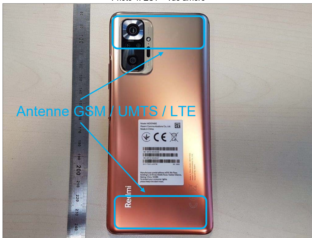
Photo 4: EST – vue arrière
