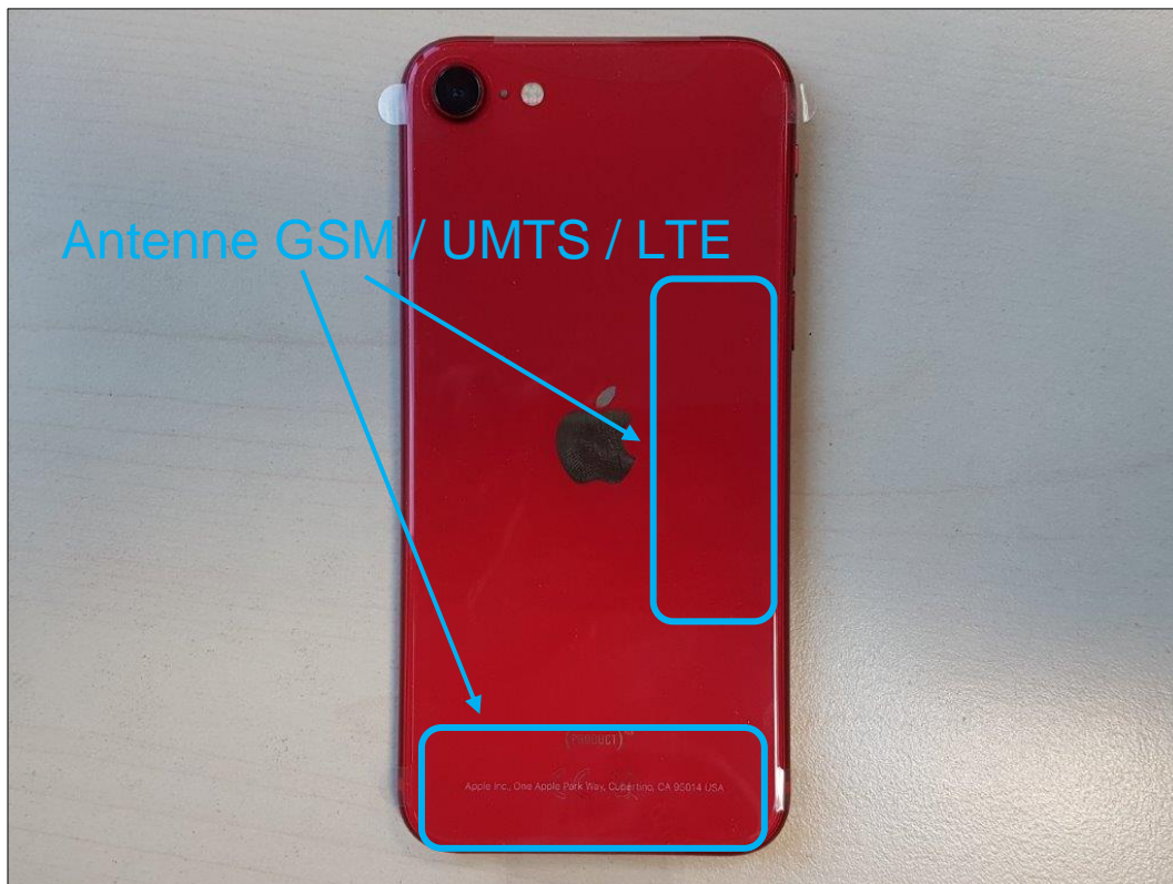
Photo 4: EST – vue arrière
