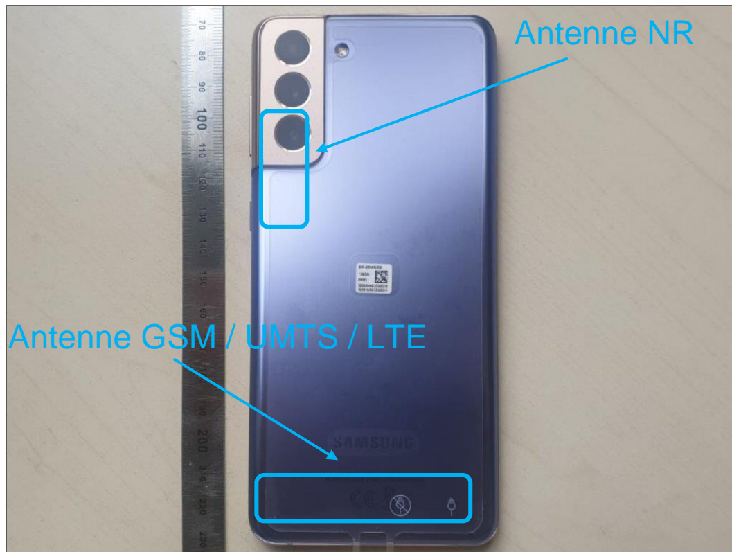
Photo 4: EST – vue arrière
