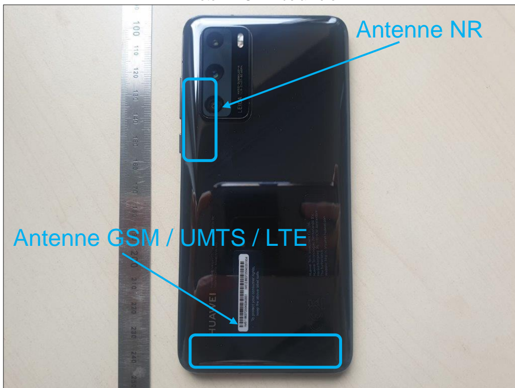
Photo 4: EST – vue arrière
