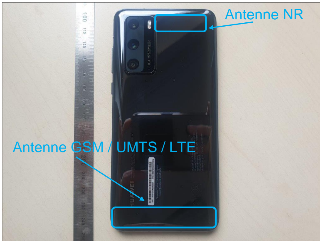
Photo 4: EST – vue arrière
