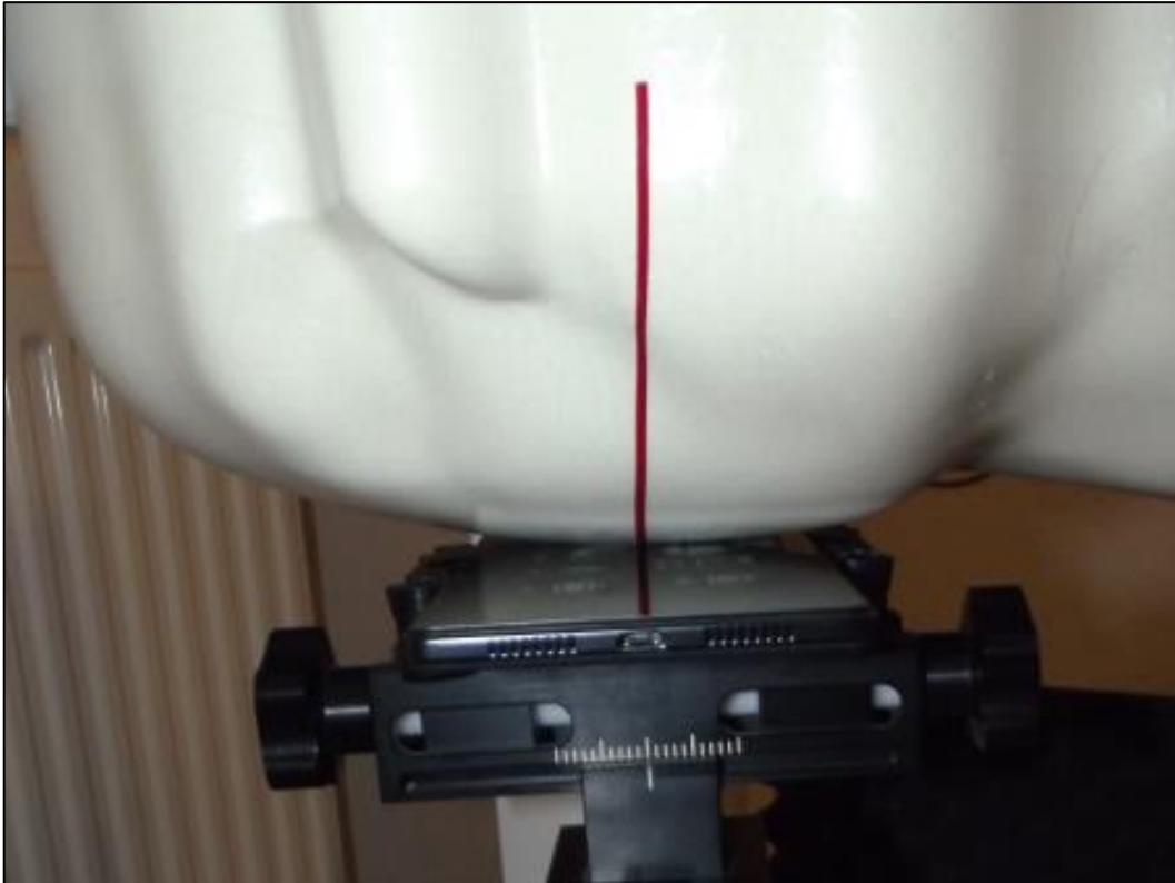
Photo 13: Position d'essai main droite, contre la joue
