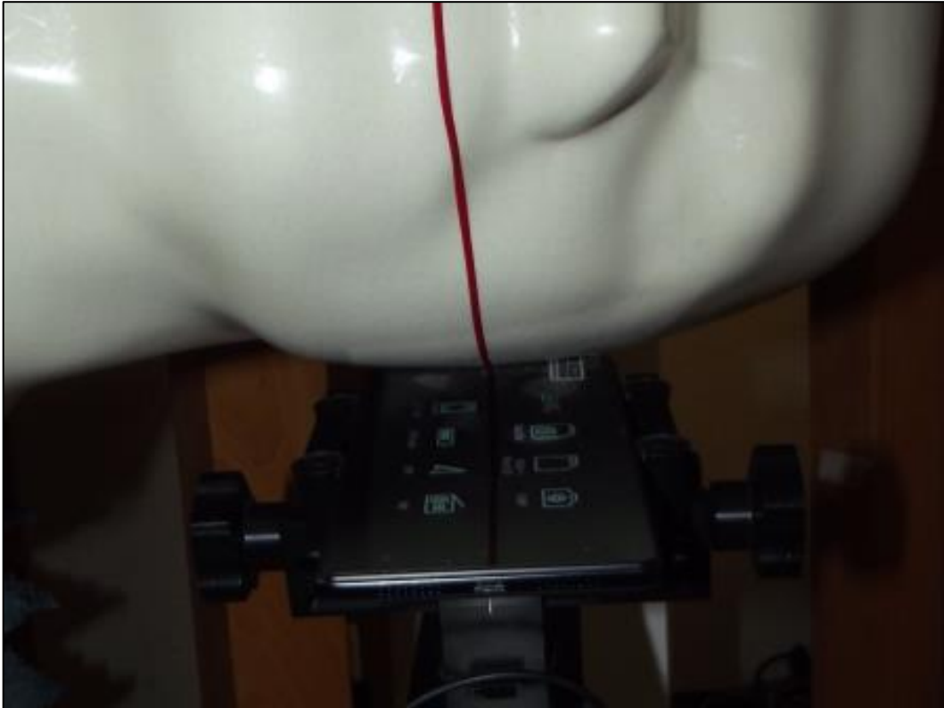
Photo 12: Position d'essai main gauche, incliné 15°
