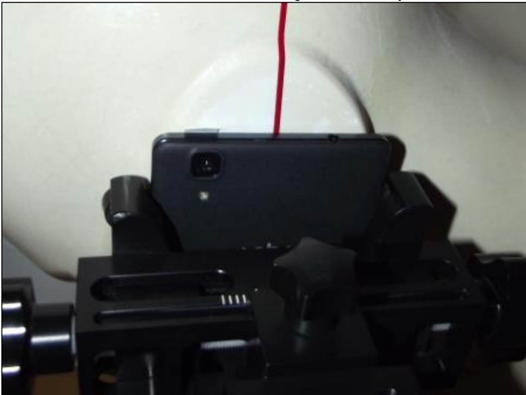
Photo 10: Position d'essai main gauche, contre la joue
