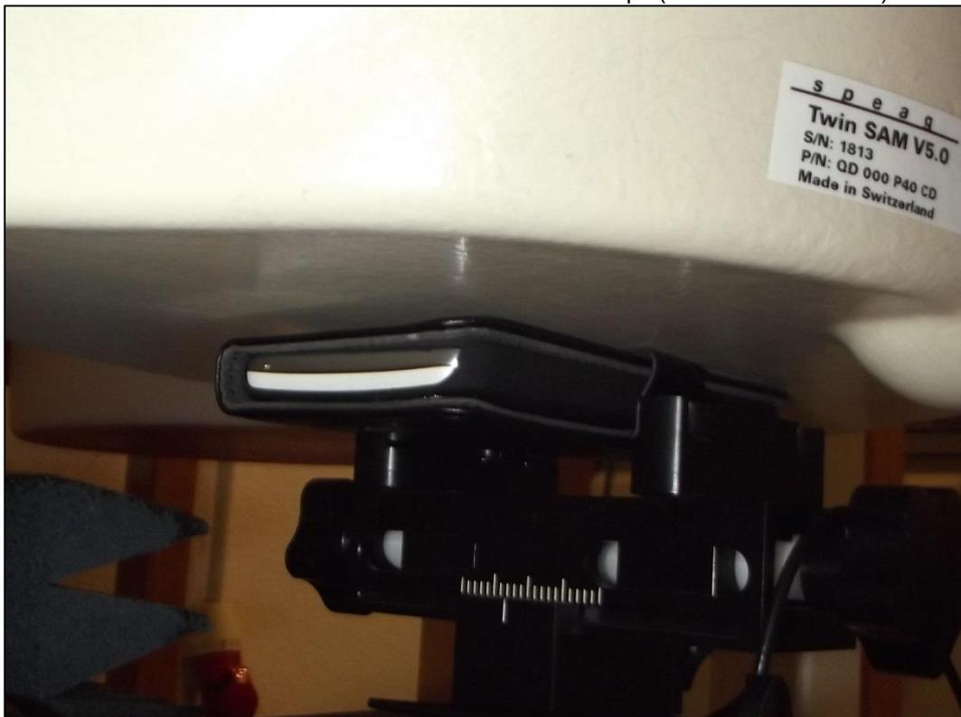
Photo 13: Position d'essai face arrière contre le corps (distance 0 mm / étui)
