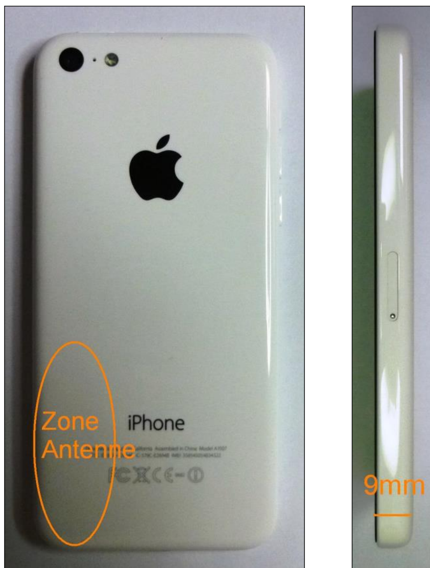
Fig. 20: Emplacement de l'antenne et épaisseur de l'équipement dans cette zone
