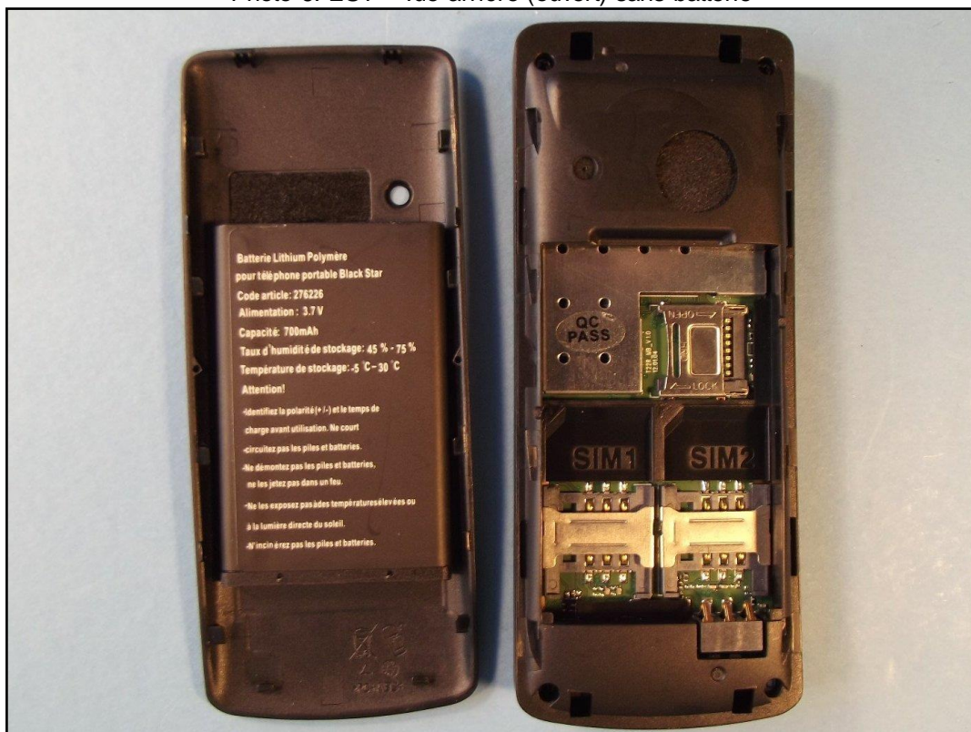
Photo 6: EST – vue arrière (ouvert) sans batterie
