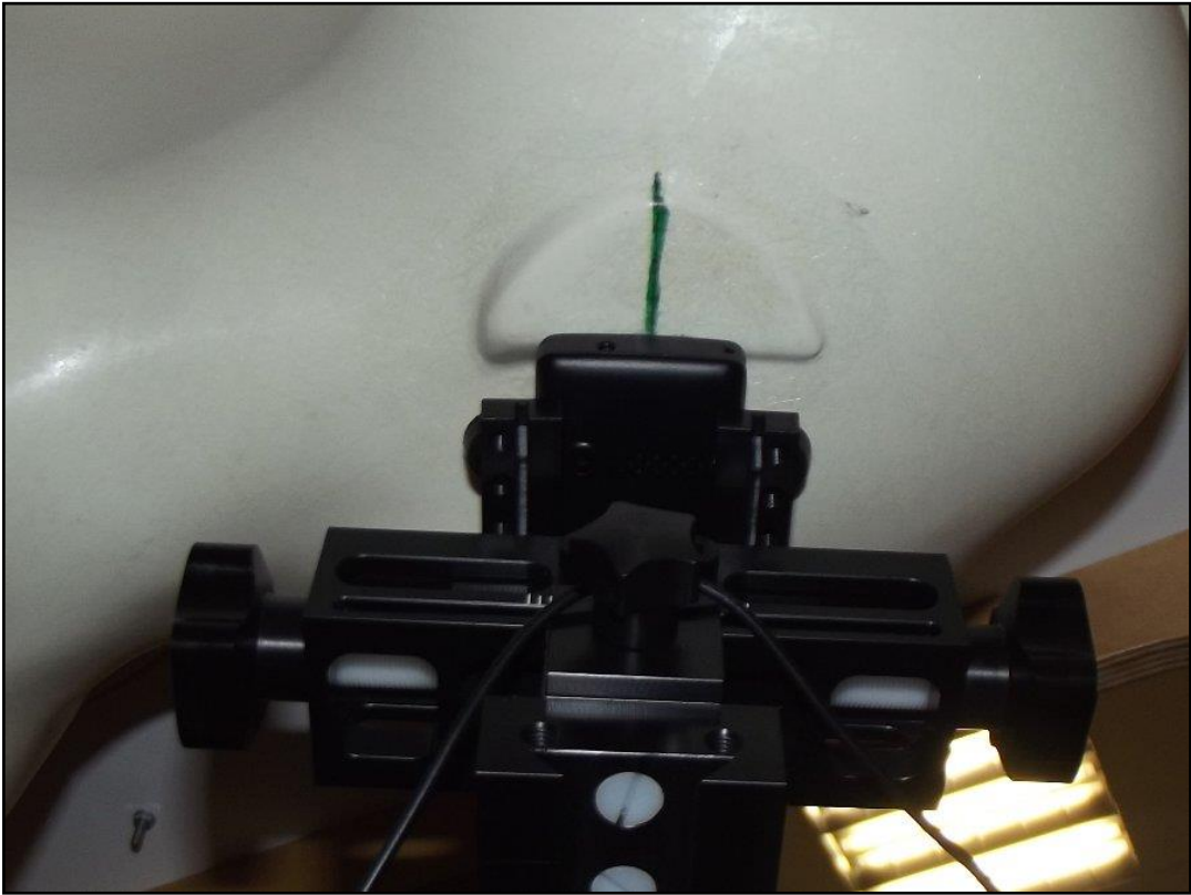
Photo 16: Position d'essai main droite, incliné 15°
