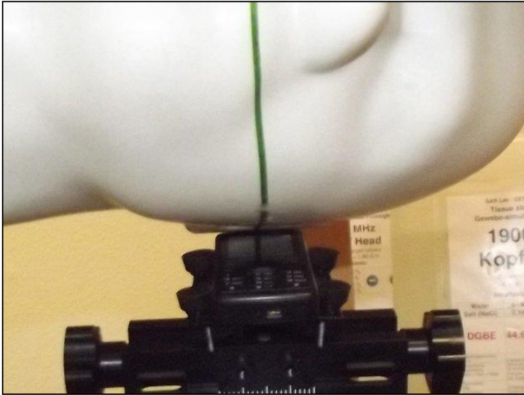
Photo 12: Position d'essai main gauche, incliné 15°
