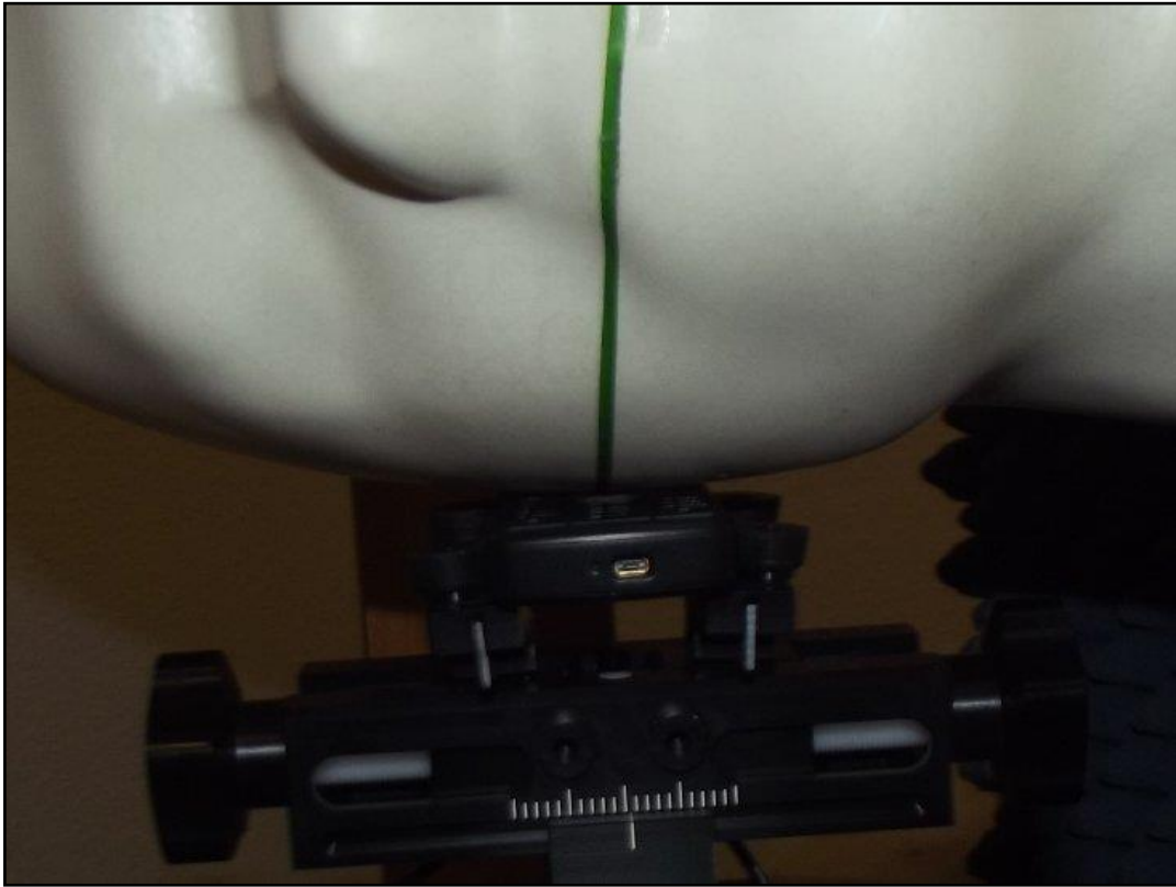
Photo 14: Position d'essai main droite, contre la joue
