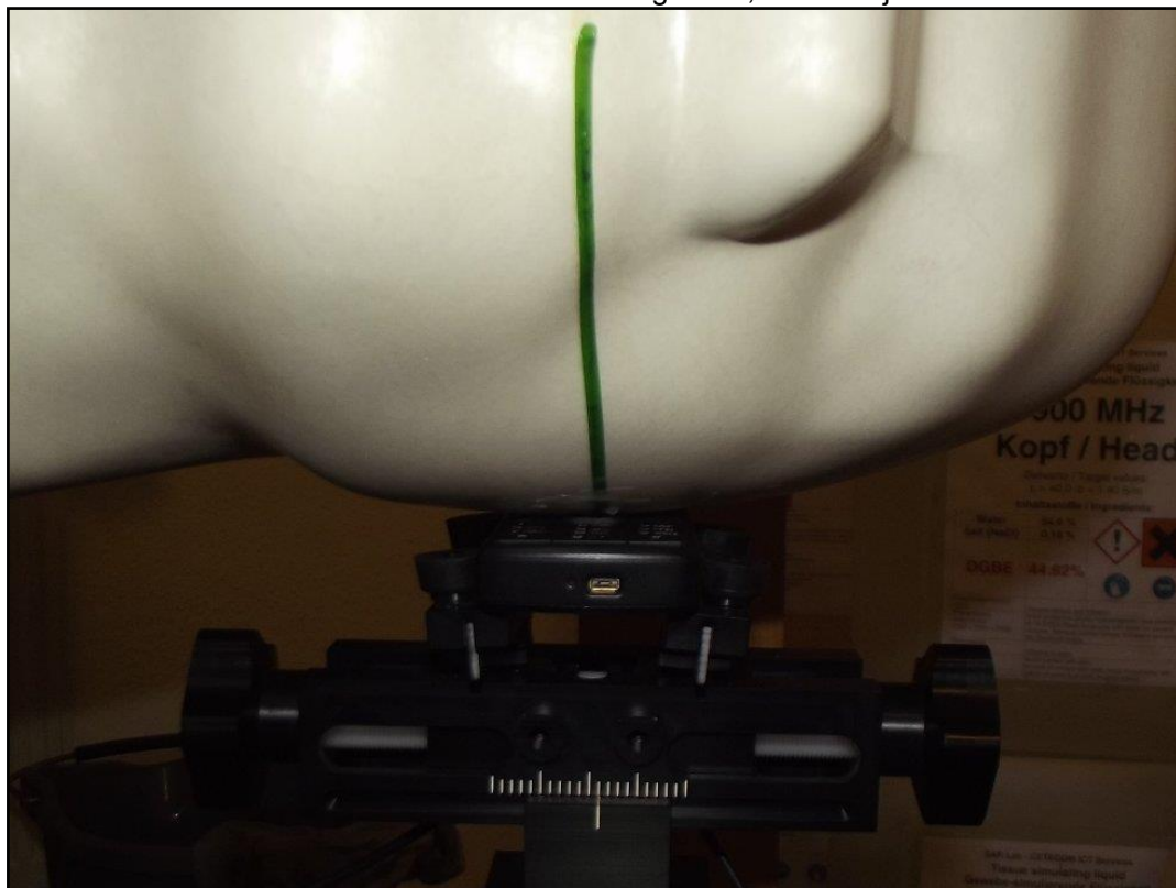
Photo 8: Position d'essai main gauche, contre la joue
