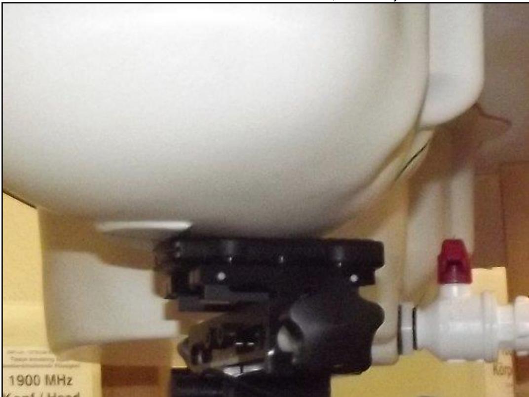
Photo 14: Position d'essai main droite, contre la joue
