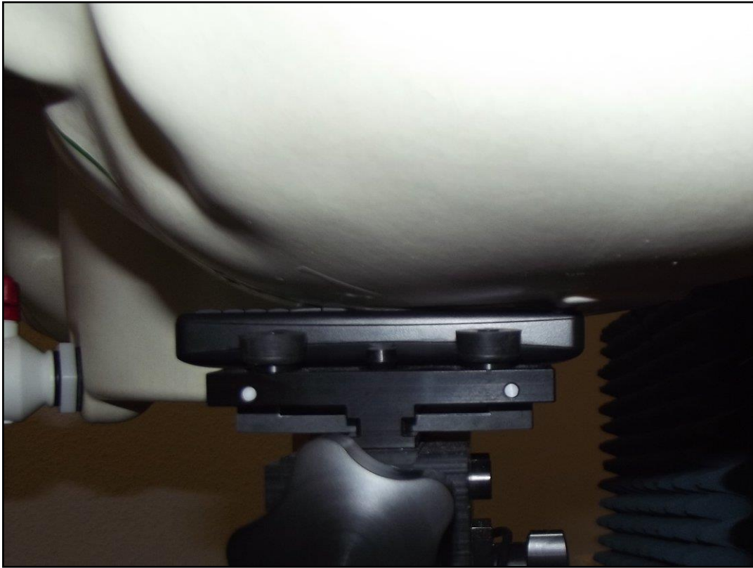
Photo 10: Position d'essai main gauche, contre la joue
