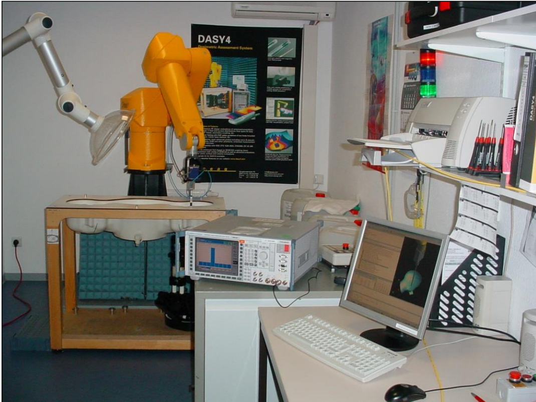
Photo 1: Banc d'essai DAS4
