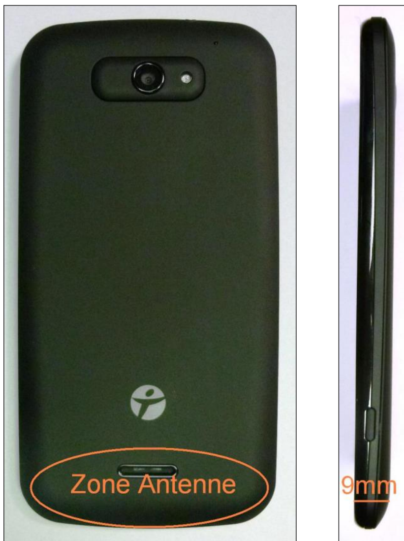
Fig. 18: Emplacement de l'antenne et épaisseur de l'équipement dans cette zone
