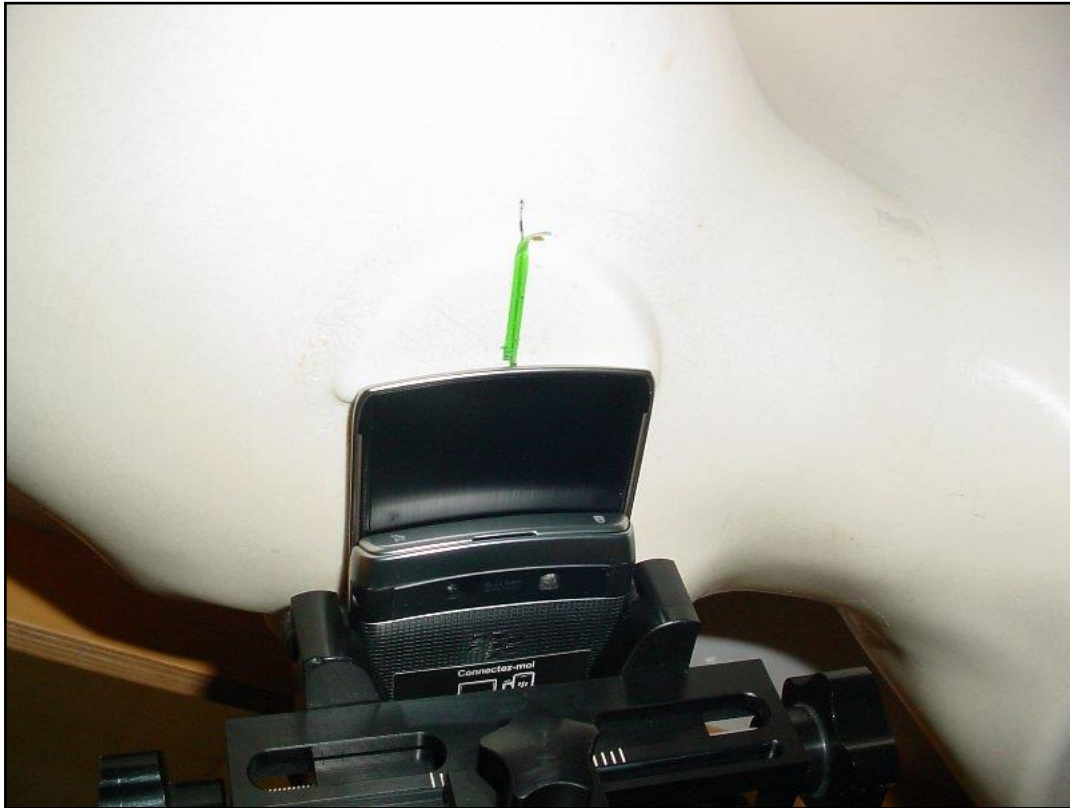
Photo 18: Position d'essai main gauche, incliné 15° (glissière ouverte)
