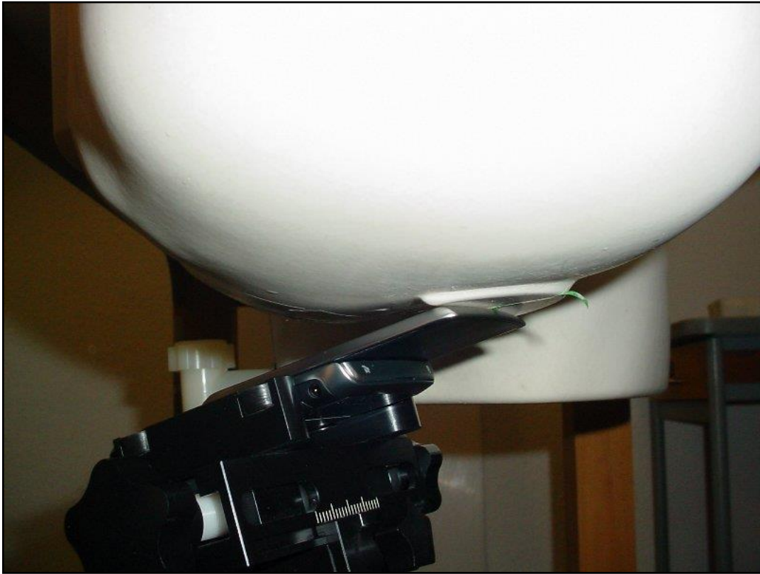
Photo 20: Position d'essai main droite, contre la joue
