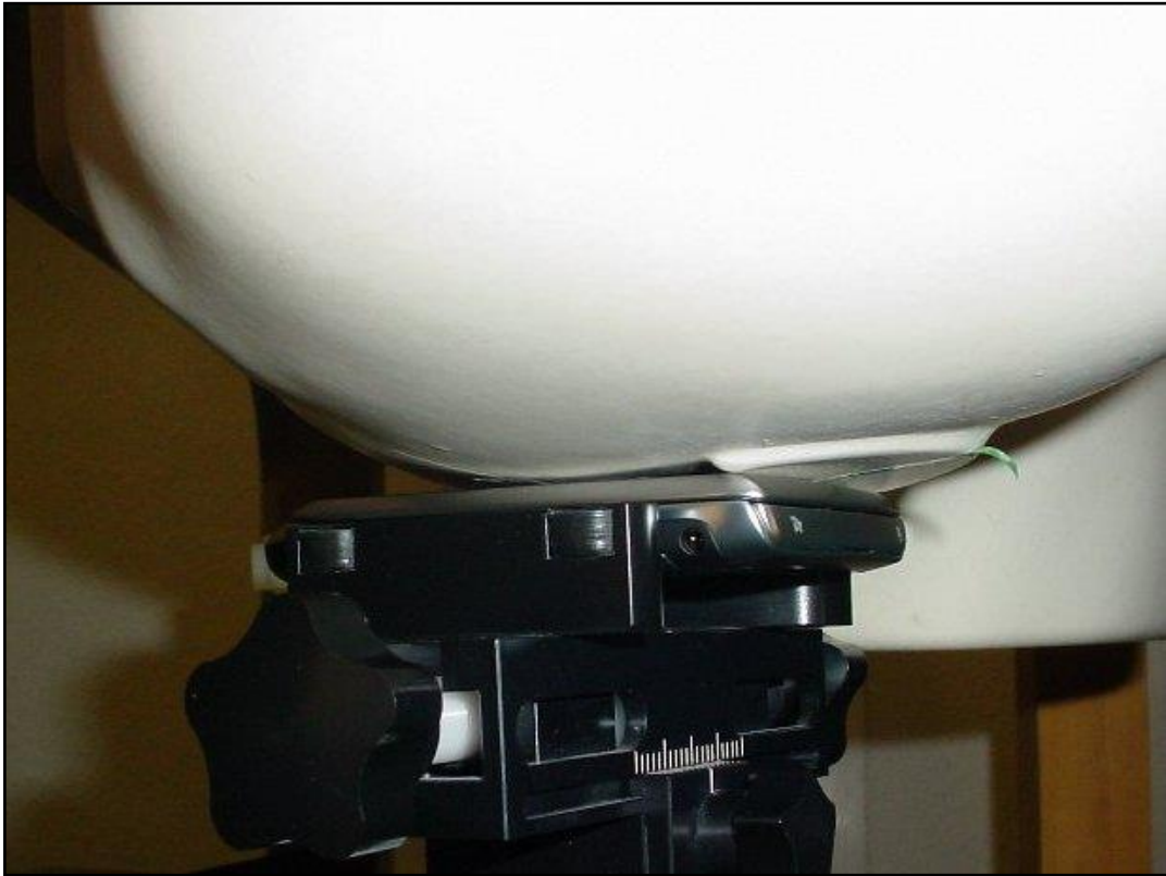
Photo 12: Position d'essai main gauche, contre la joue
