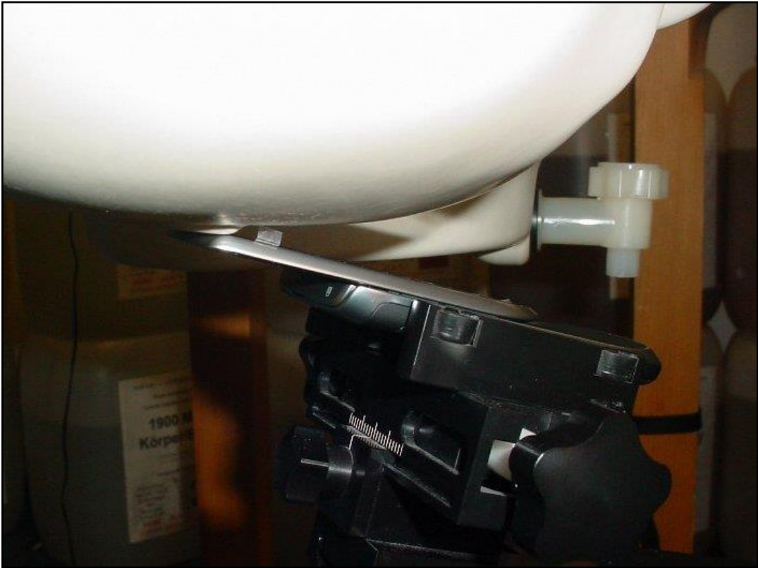
Photo 29: Position d'essai main droite, incliné 15° (glissière ouverte)
