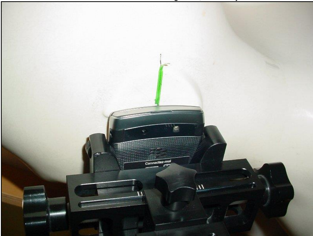
Photo 12: Position d'essai main gauche, contre la joue
