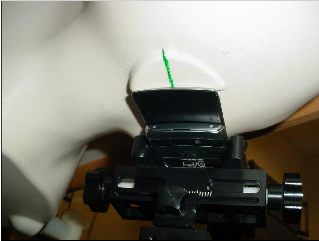
Photo 28: Position d'essai main droite, incliné 15° (glissière ouverte)
