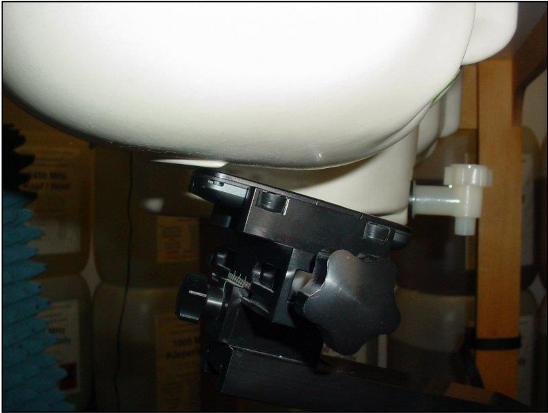
Photo 17: Position d'essai main droite, incliné 15°
