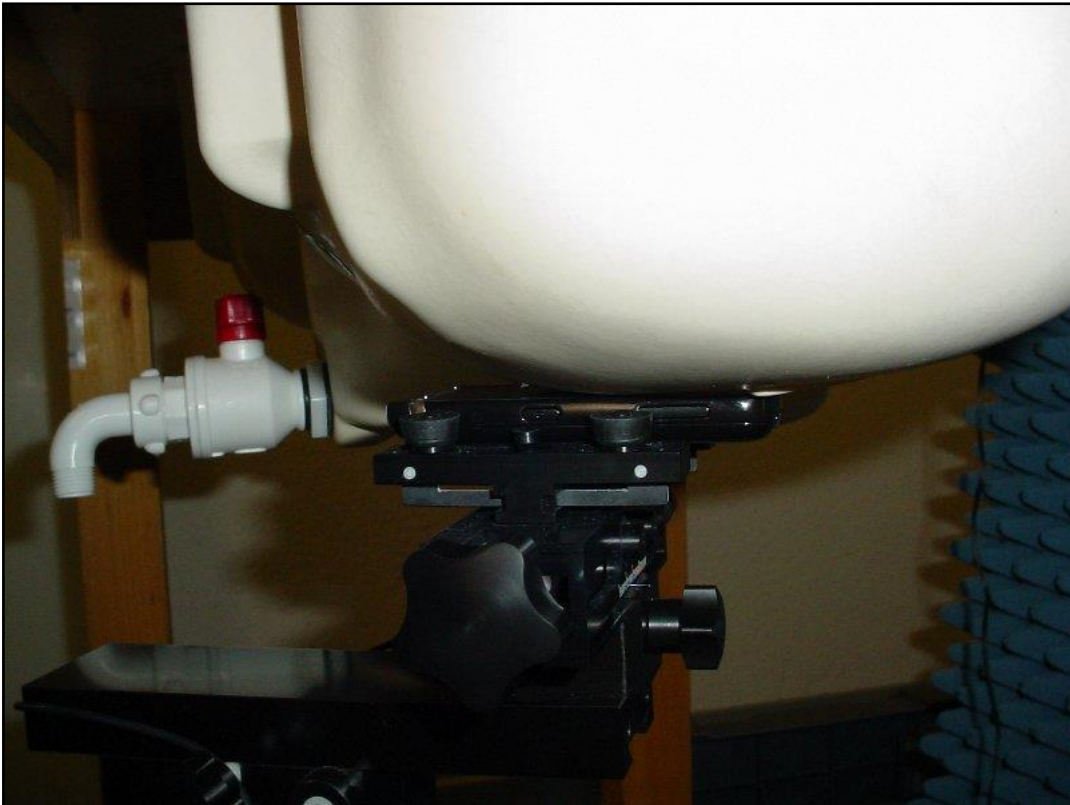
Photo 9: Position d'essai main gauche, contre la joue
