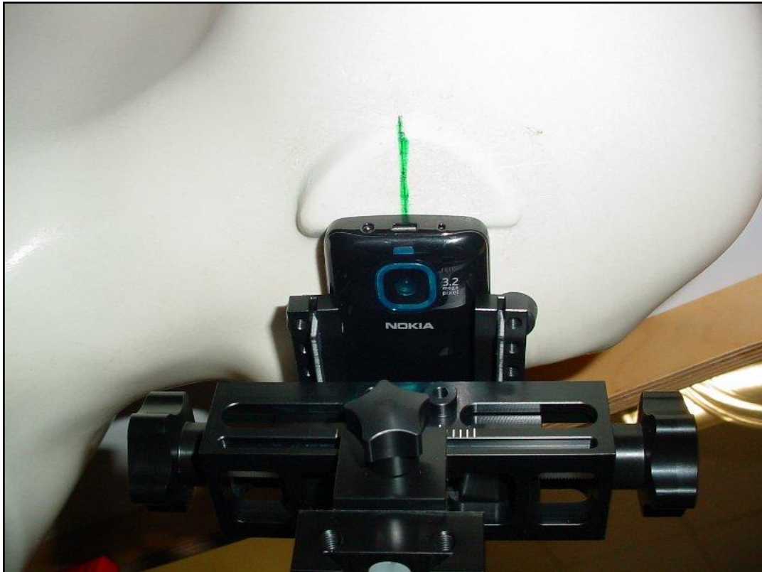
Photo 15: Position d'essai main droite, contre la joue
