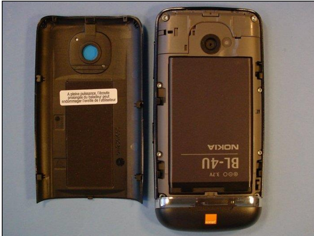
Photo 5: EST – vue arrière (ouvert) avec batterie
