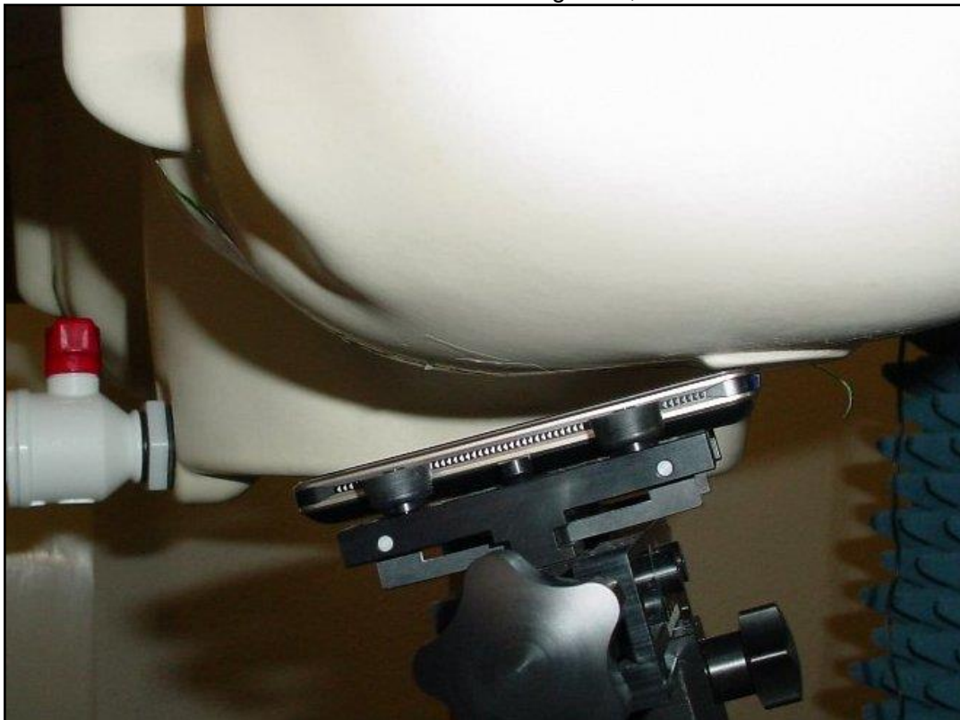
Photo 12: Position d'essai main gauche, incliné 15°
