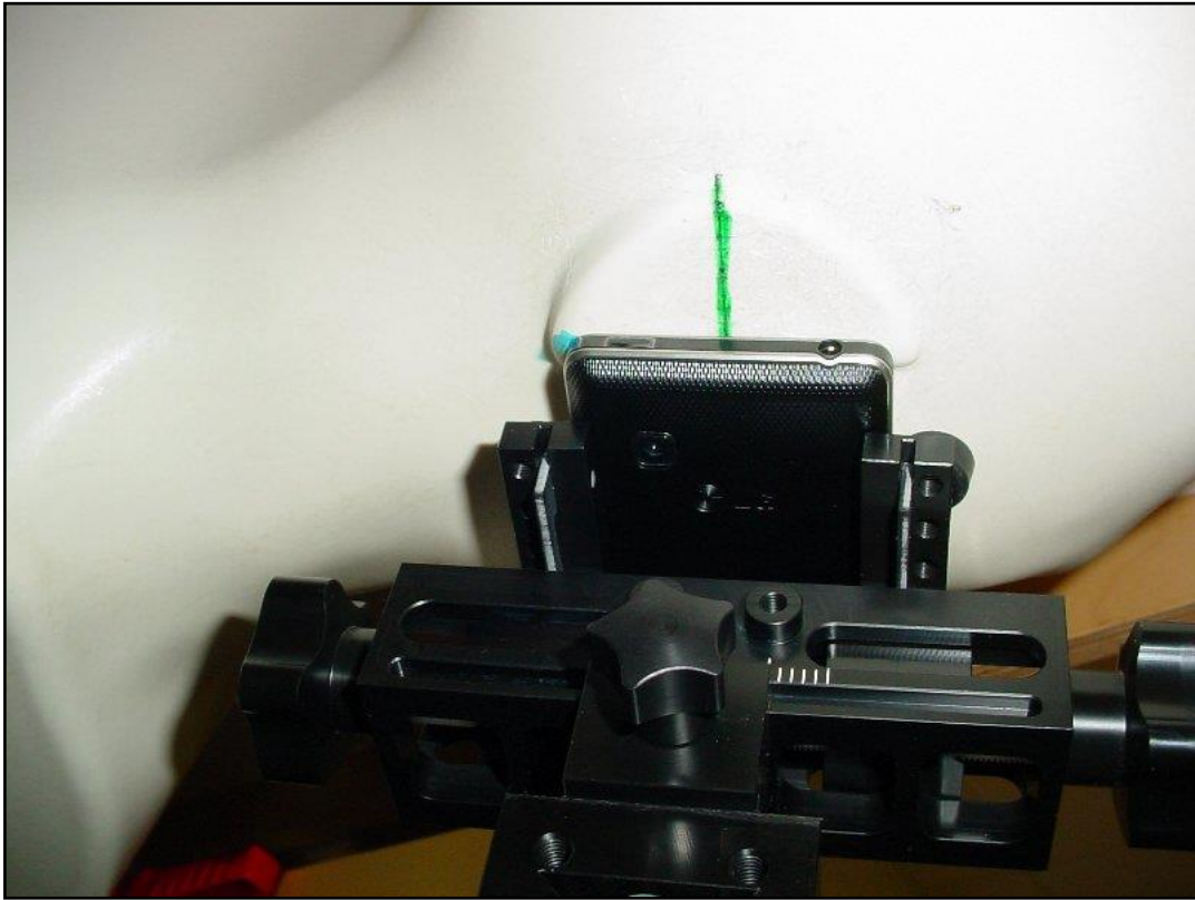
Photo 16: Position d'essai main droite, incliné 15°
