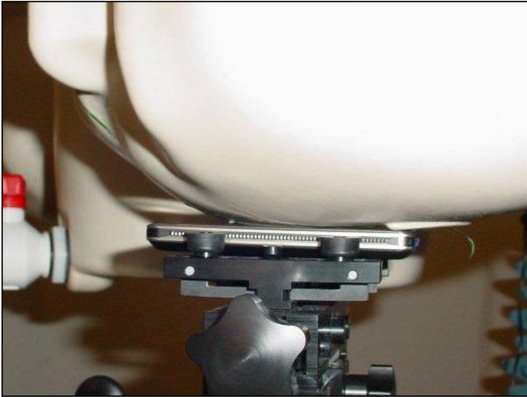
Photo 10: Position d'essai main gauche, contre la joue
