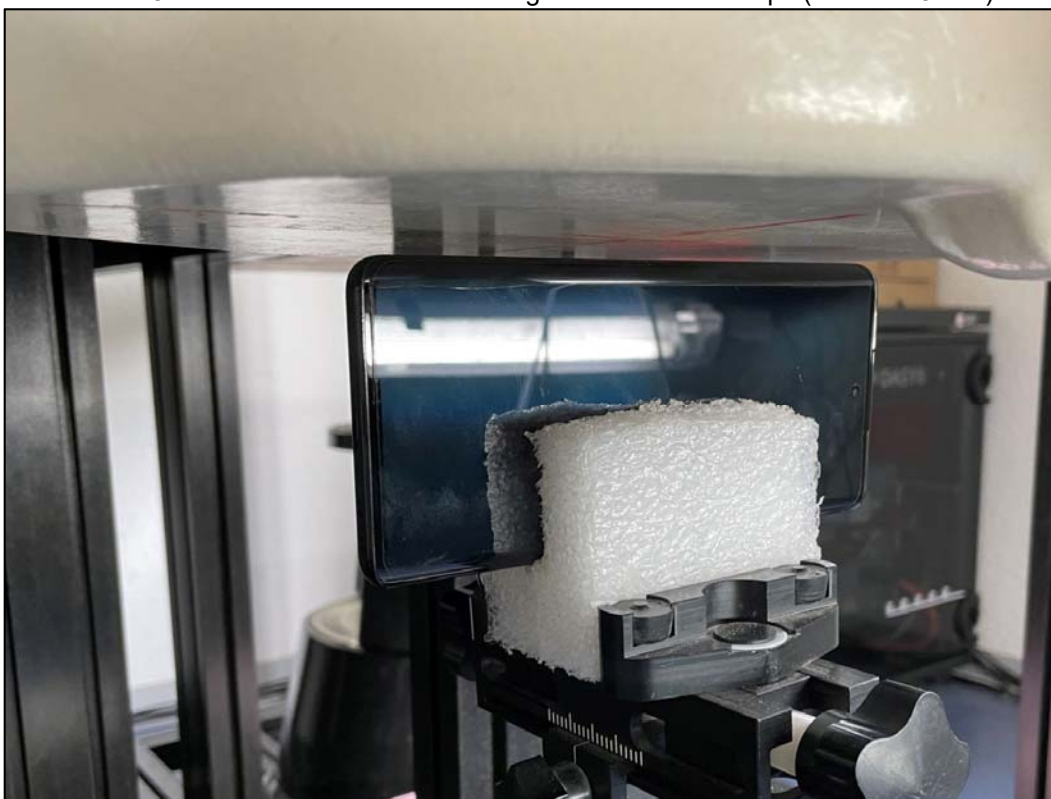
Photo 9: Position d'essai face du côté droite contre le corps (distance 5 mm)
