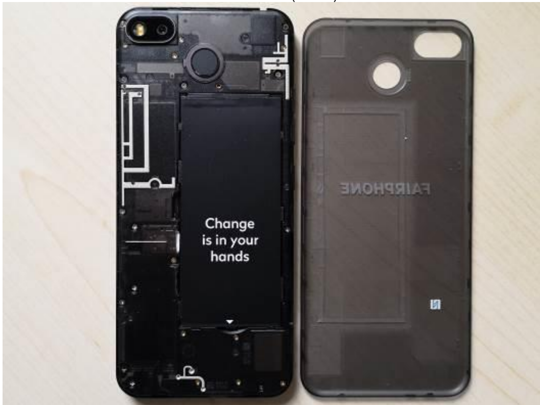
Photo 6: EST – vue arrière (ouvert) sans batterie
