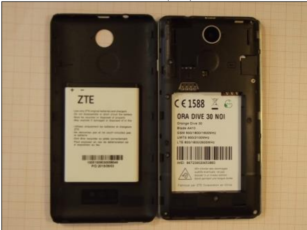
Photo 6: EST – vue arrière (ouvert) sans batterie
