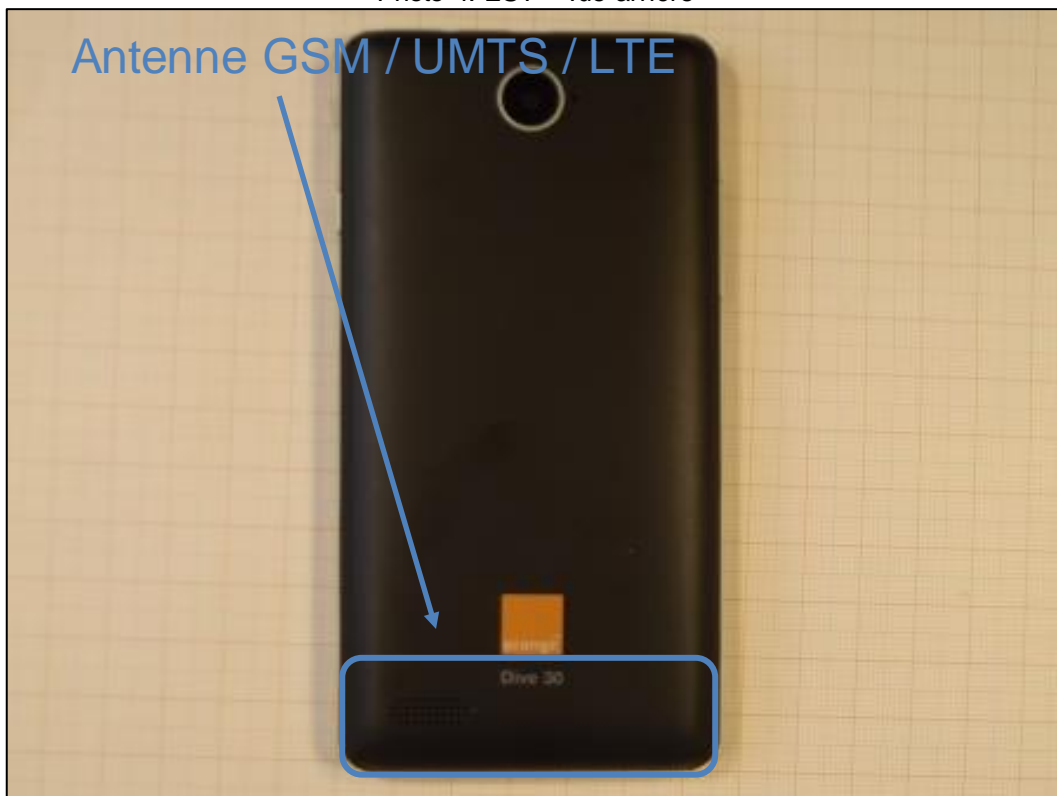
Photo 4: EST – vue arrière
