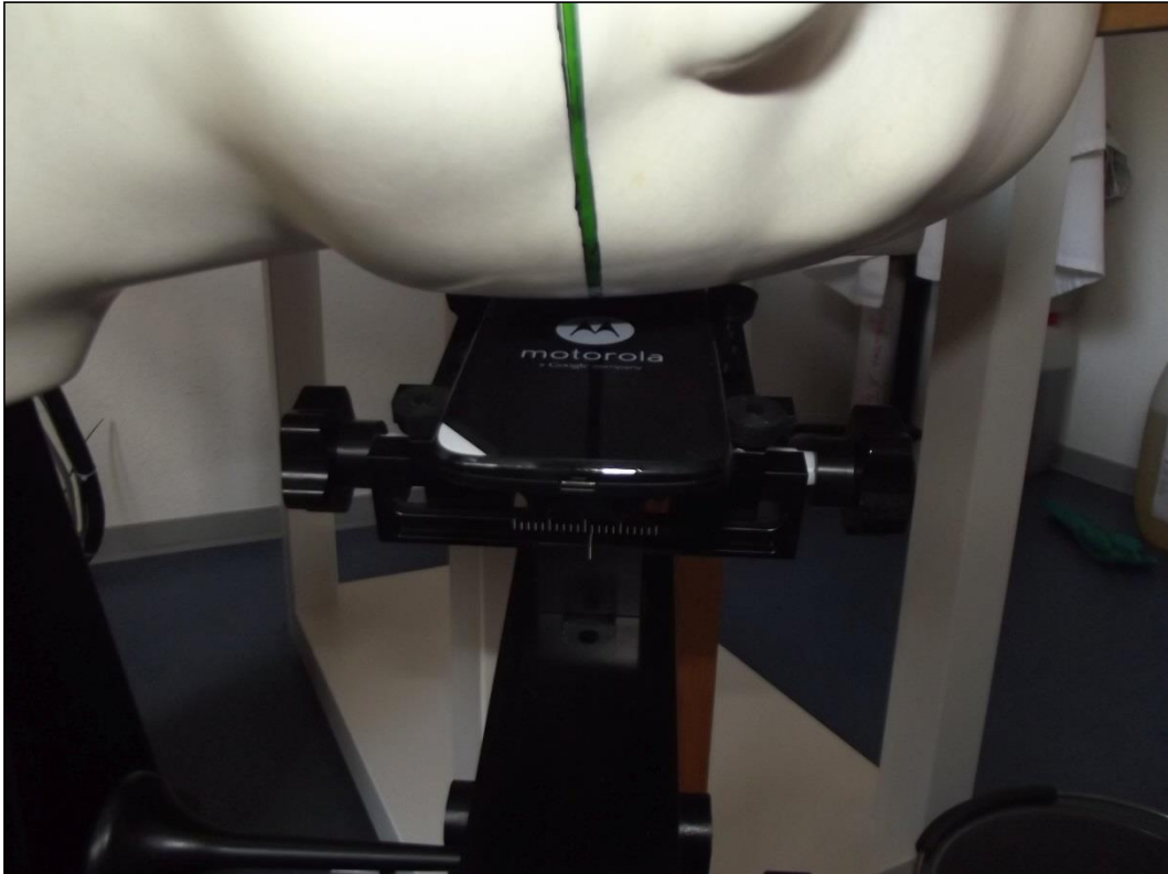
Photo 10: d'essai main gauche, incliné 15°
