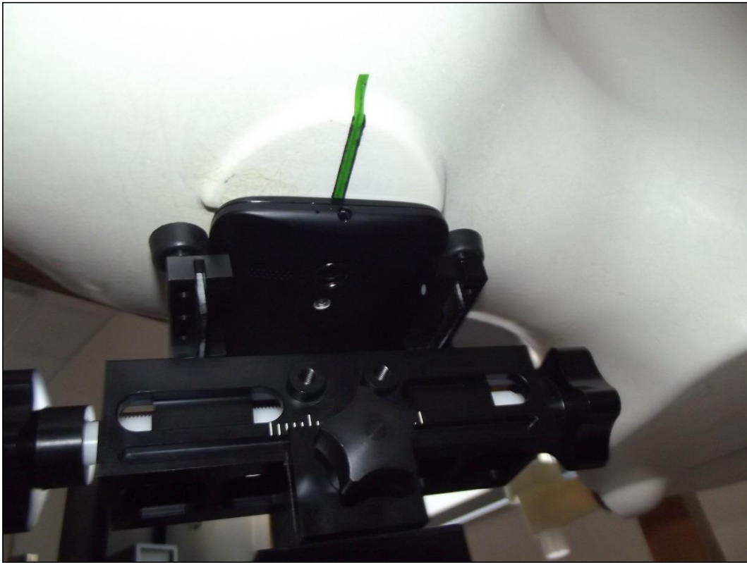
Photo 10: d'essai main gauche, incliné 15°
