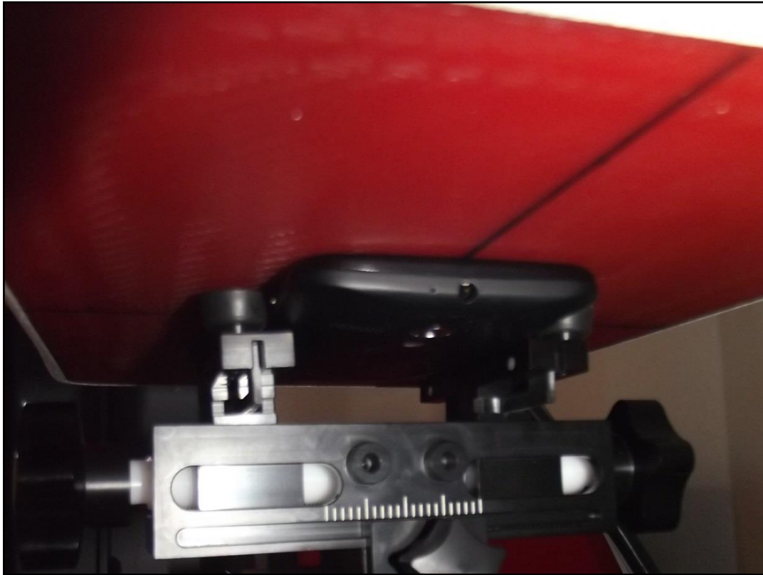
Photo 8: EST - Position d'essai face arrière contre le corps (distance 0 mm)
