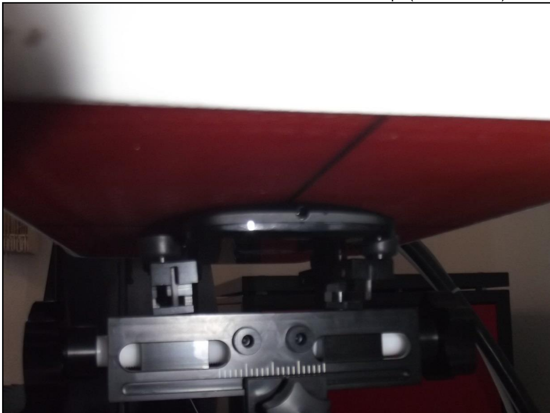
Photo 8: EST - Position d'essai face arrière contre le corps (distance 0 mm)
