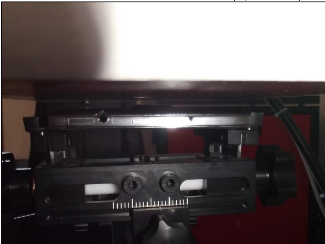
Photo 10: EST - Position d'essai face arrière contre le corps (distance 5 mm)
