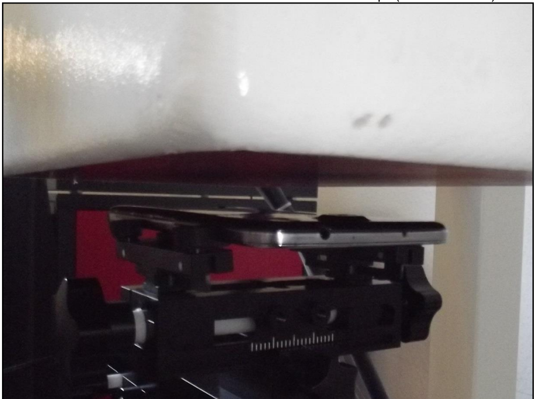
Photo 12: EST - Position d'essai face arrière contre le corps (distance 15 mm)
