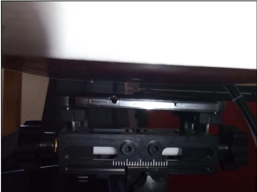
Photo 11: EST - Position d'essai face arrière contre le corps (distance 10 mm)
