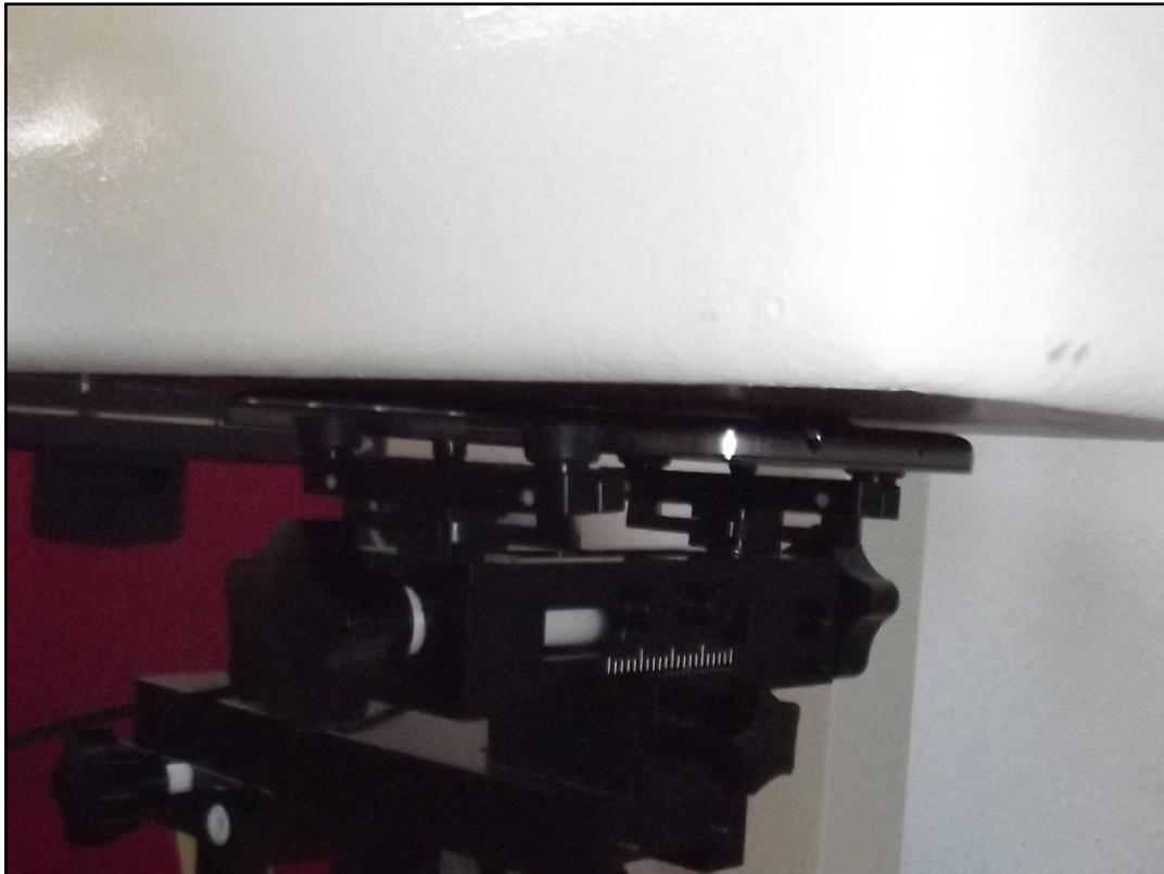
Photo 9: EST - Position d'essai face arrière contre le corps (distance 0 mm)
