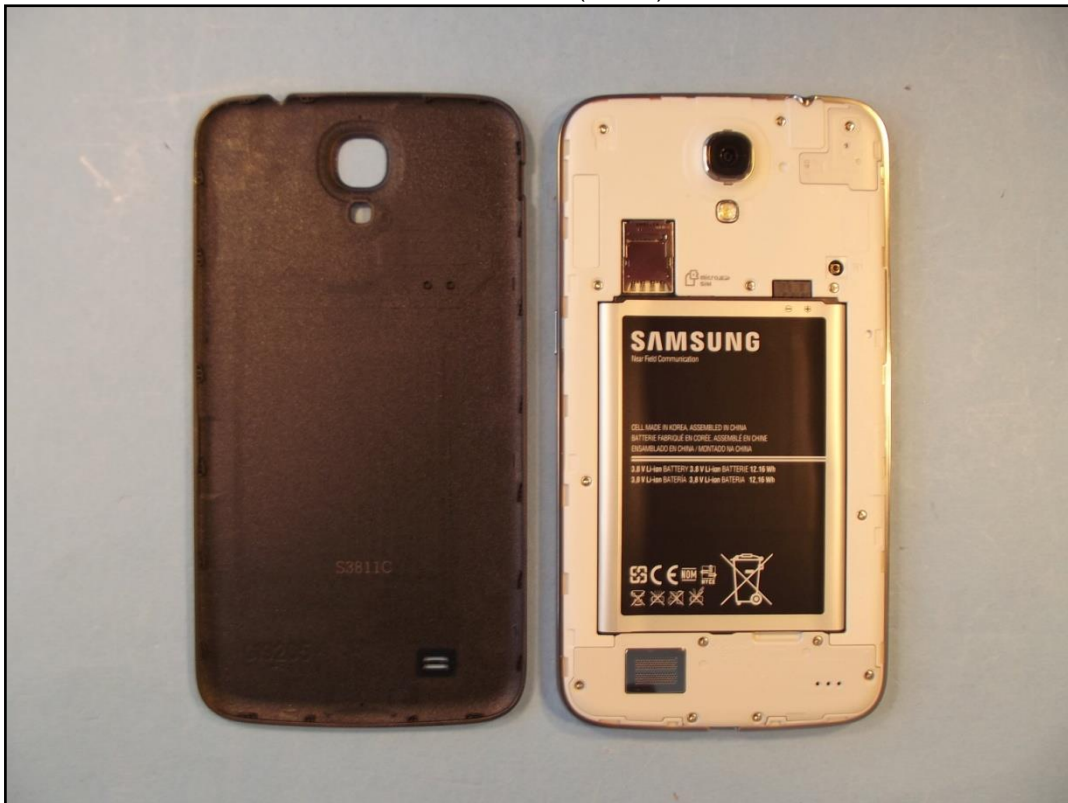
Photo 5: EST – vue arrière (ouvert) avec batterie
