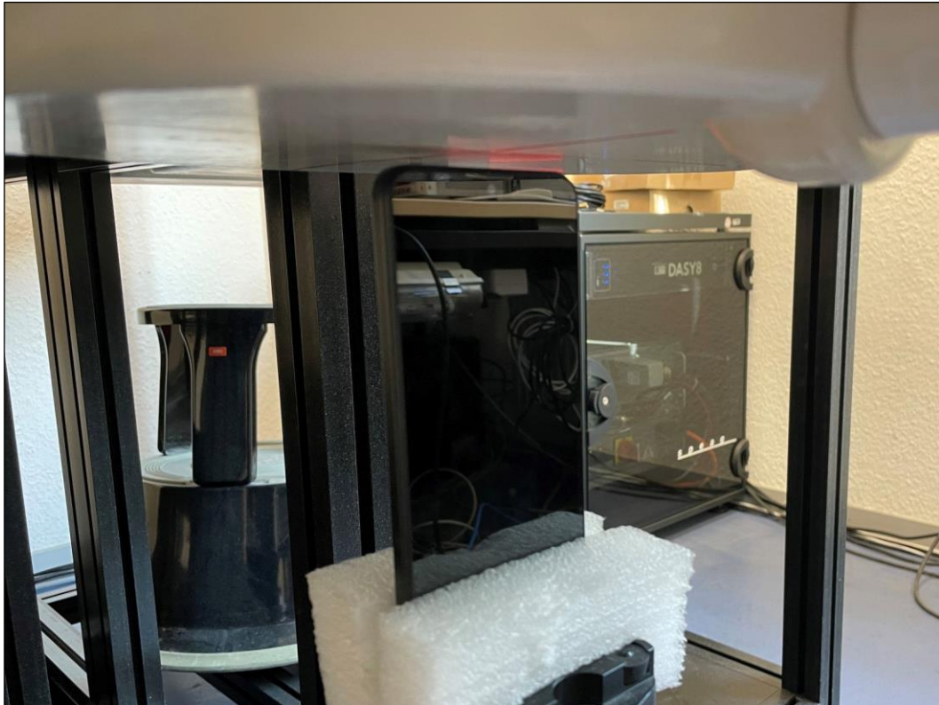
Photo 13: Position d'essai face du dessous contre le corps (distance 5 mm)
