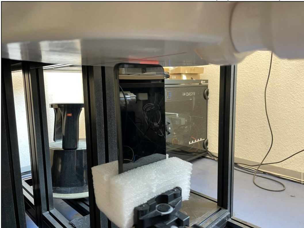
Photo 13: Position d'essai face du dessous contre le corps (distance 5 mm)
