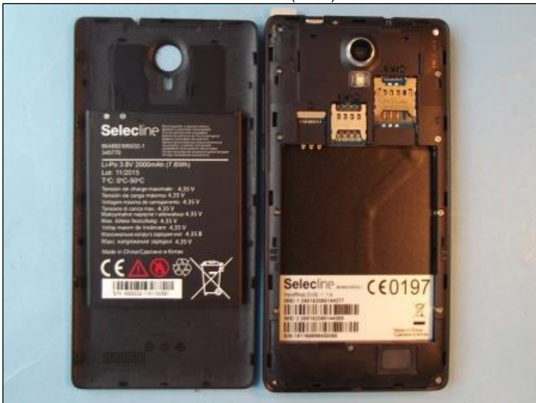
Photo 6: EST – vue arrière (ouvert) sans batterie
