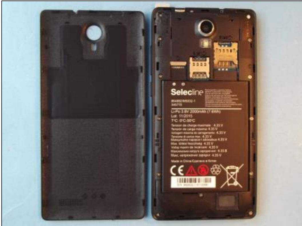
Photo 5: EST – vue arrière (ouvert) avec batterie
