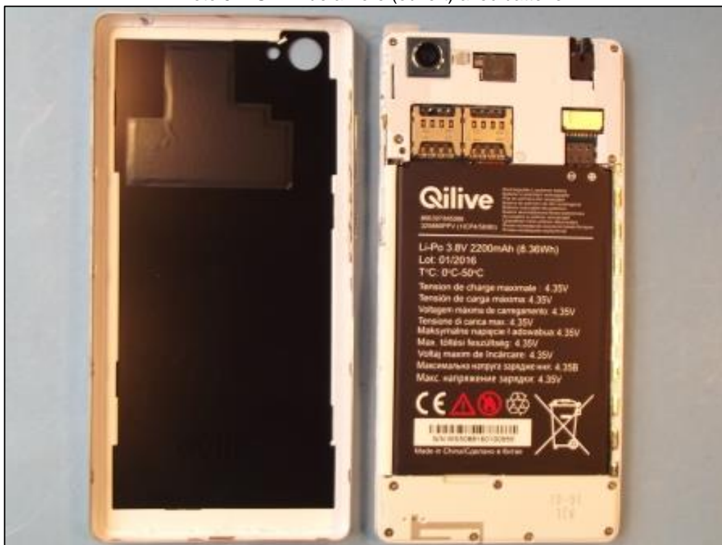
Photo 5: EST – vue arrière (ouvert) avec batterie
