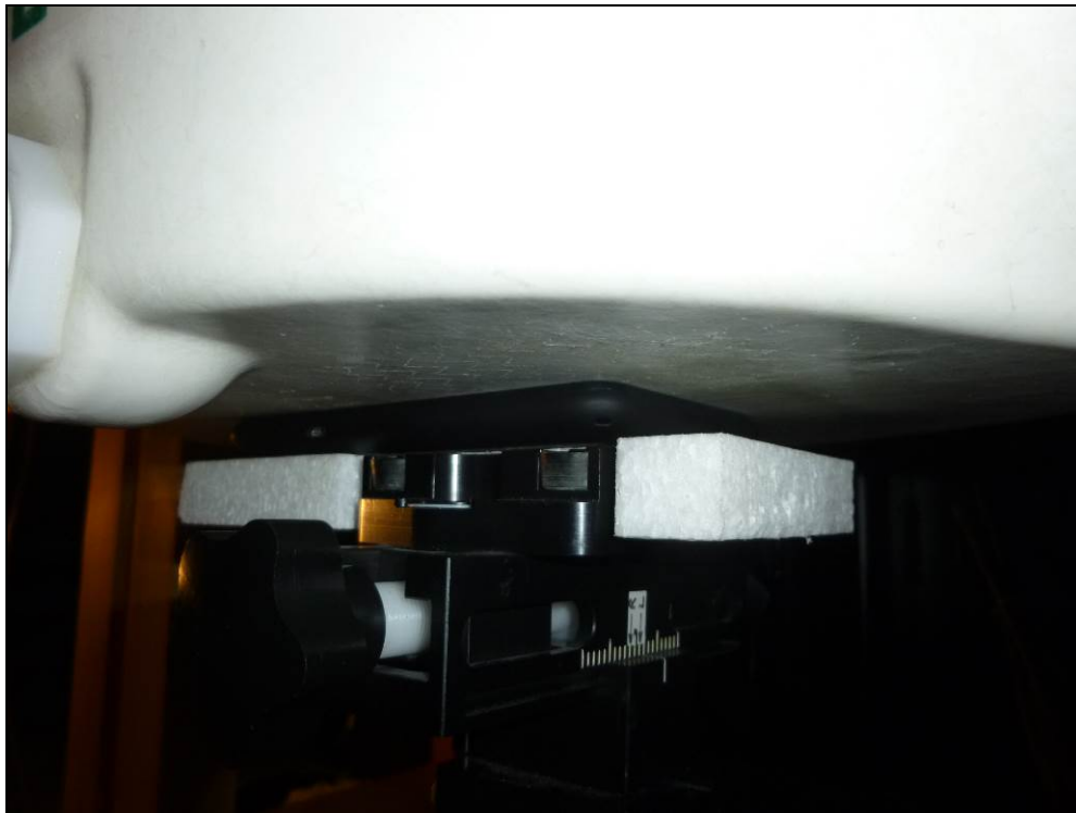
Fig. 15: Face avant à 0cm du fantôme SAM
