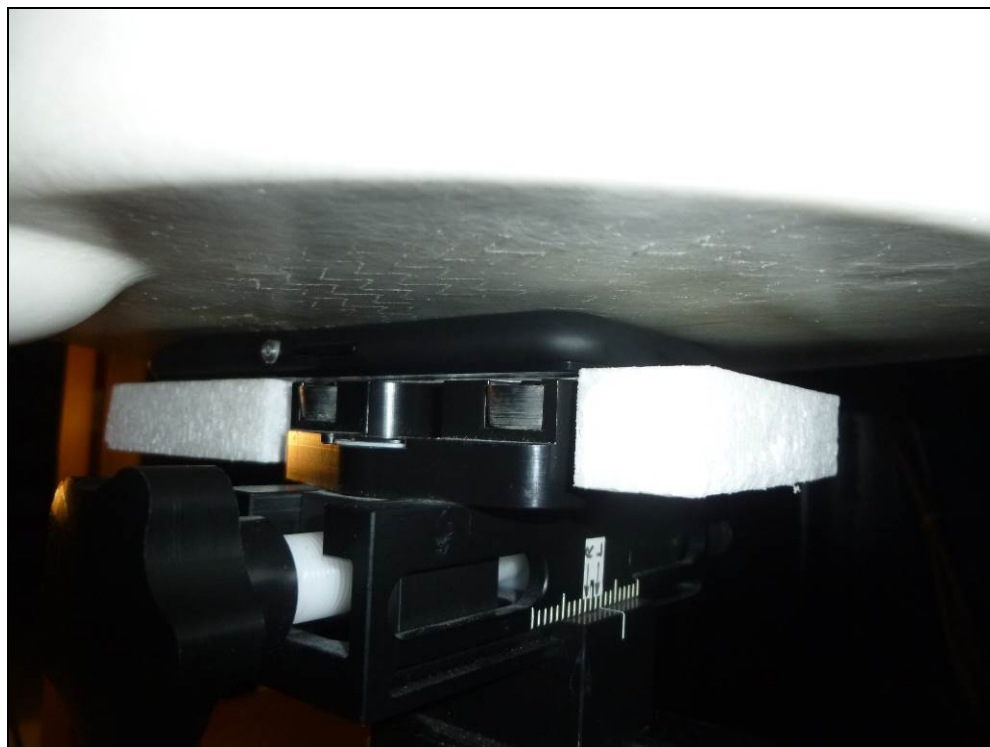
Fig. 16: Face arrière à 0cm du fantôme SAM
