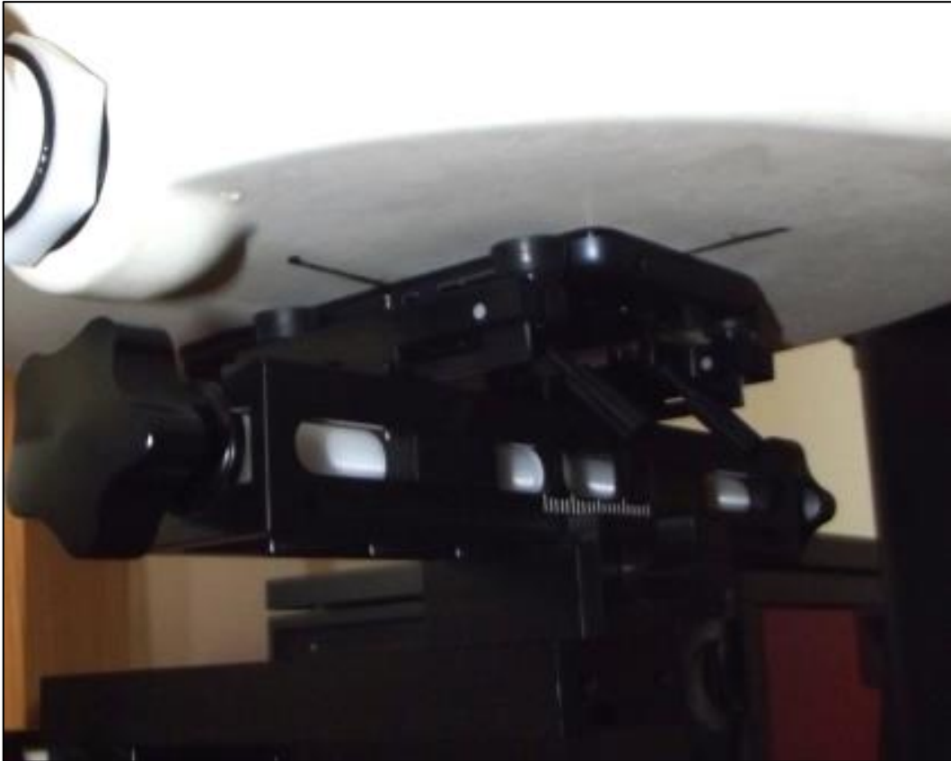
Photo 9: Position d'essai face avant contre le corps (distance 0 mm)
