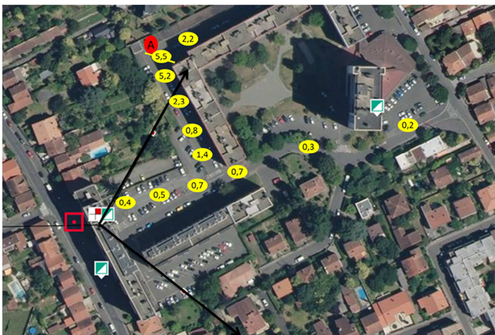
Figure 14 : vue satellite du site de Toulouse avec en rouge la position du CPE et en jaune les niveaux de champ mesurés en en V/m en différents points pour une émission continue sur 50 MHz de largeur de bande avec une puissance maximale de 200 W.
