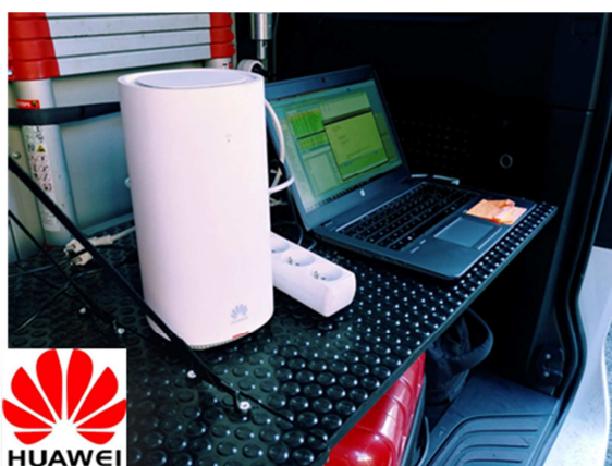
Figure 5 : CPE « customer premise equipment », équipement servant de mobile de test pour générer du trafic dans une direction donnée.
