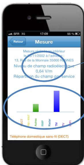
Résultat de la mesure exprimé en volt par mètre (V/m).
