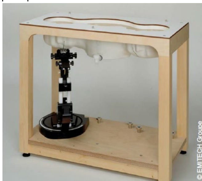
Figure 4 : exemple de téléphone placé contre le mannequin représentant la tête remplie de liquide
