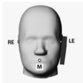
Figure 5: illustration des deux positions d'essai normalisées pour tester les équipements utilisés contre l'oreille
