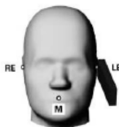
Figure 2: illustration des deux positions d'essai normalisées pour tester les équipements utilisés contre l'oreille
