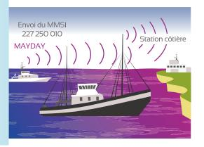
Avec l'option ASN de votre VHF, par un simple appui prolongé sur la touche de détresse, l'appel de détresse est transmis vers la terre et vers les autres navires se trouvant sur zone.
