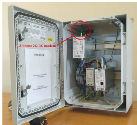
Figure 4 : visualisation de l'antenne du modem 2G/3G
