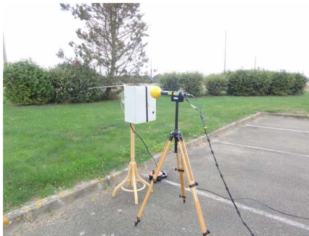
Figure 3 : installation de la composante VHF/UHF sur un trépied pour la réalisation des essais
