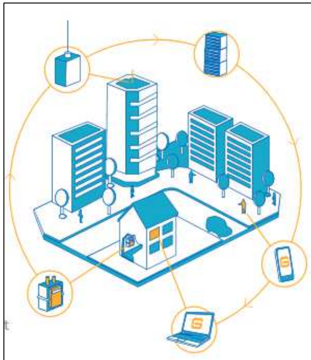
Figure 1 : principe de la chaîne communicante de la solution technique de télé relevé retenu par GRDF – source GRDF
