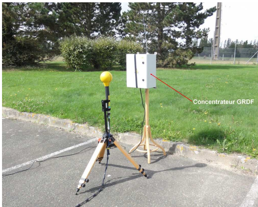
Figure 14 : configuration de mesure lors des essais COFRAC.
