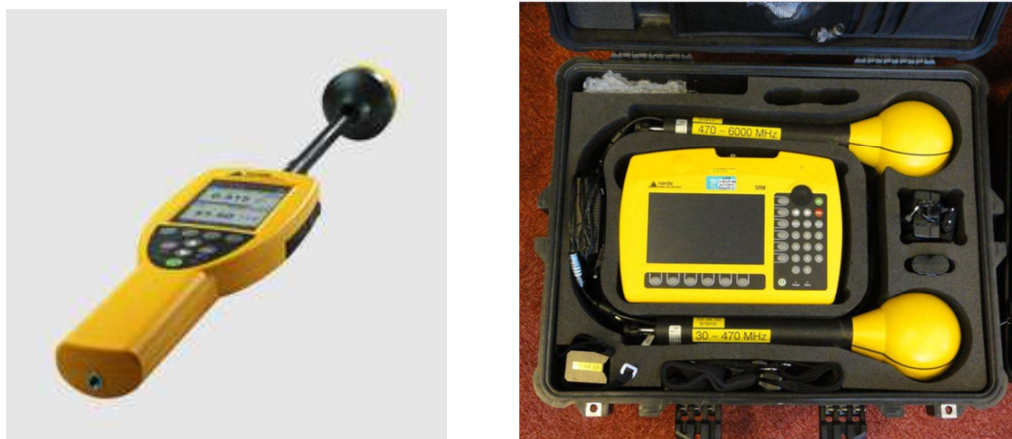
Figure 5 : matériels de mesure des champs électriques large bande à gauche et sélectif en fréquence à droite
