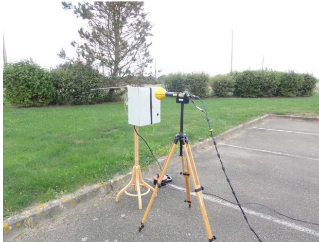
Figure 10 : installation du concentrateur pour réaliser les mesures de champ en fonction de la distance. Le concentrateur se connecte automatiquement au réseau existant.
